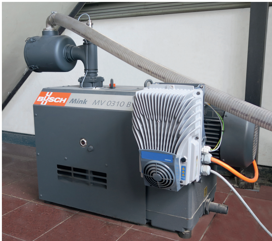
Bild 2. Eine der drei Klauen-Vakuumpumpen zur Vakuumversorgung der Förderanlage bei Jedi Kunststofftechnik (© Busch)
